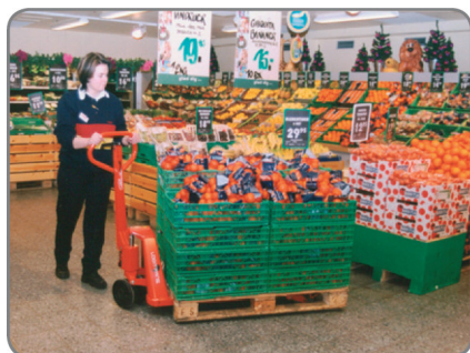
Beállítható alátolási magasság - az alacsony és elhasznált raklapok se jelentenek problémát.
